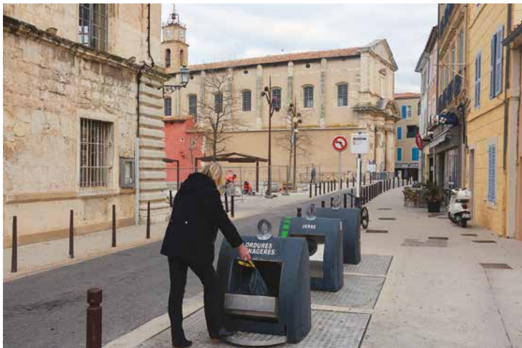
Huit séries de trois conteneurs enterrés et permettant le tri sont installés dans l'ensemble du centre-ville.
