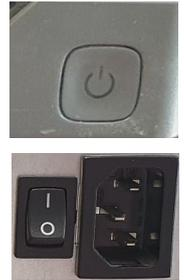
*Note : Si les voyants de l'UC ne s'allument pas, vérifiez que le bouton à côté de la prise d'alimentation derrière l'UC est bien sur « 1 »*
